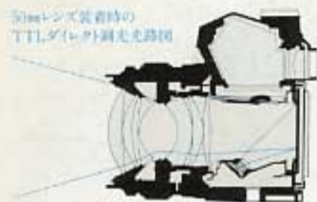
50mmレンズ装着時の スポット測光光路図
