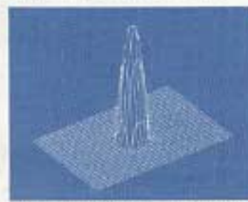
3D方式により表現されたスポット測光の感度分布図
